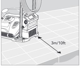
Positionieren Sie das Stromversorgungsgerät so, dass es sich in einem Abstand von 3m/10ft ungefähr in der Mitte der Pool-Längsseite befindet.
