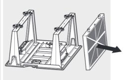
Öffnen Sie die Schnappverschlüsse und entfernen Sie die Filter.
