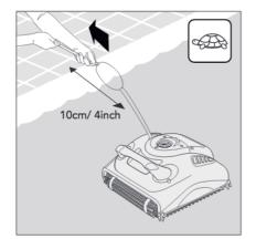
Ziehen Sie den Poolreiniger am Schwimmkabel zum Poolrand. Ziehen Sie den Poolreiniger am Griff aus dem Pool.
